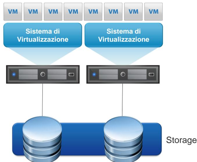
Come illustrato in figura il sistema dovrà essere composto da almeno n. 2 macchine fisiche con le quali implementare il sistema di virtualizzazione ed una Storage Area Network che dovrà garantirà la piena efficienza dell'ambiente virtuale, l'ottimizzazione dello spazio disco e la totale ridondanza dei dati in caso di failure di una componente dell'infrastruttura.
