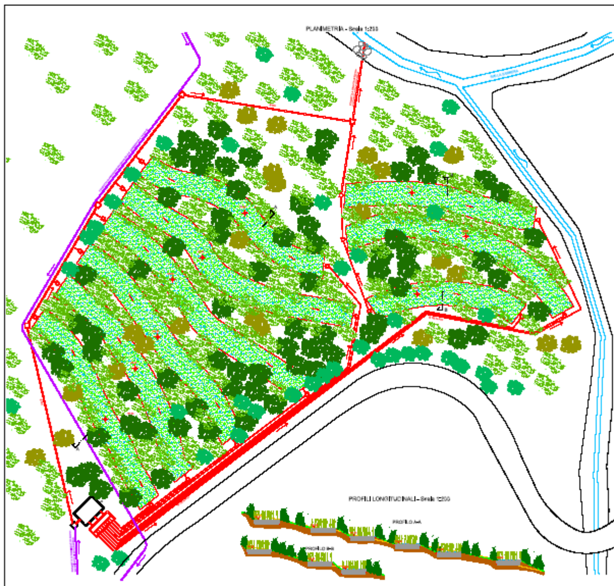
Figura 4-7: Planimetria e profili longitudinali della sezione di fitodepurazione - estratto della Tavola 3.30 allegata al Progetto definitivo
