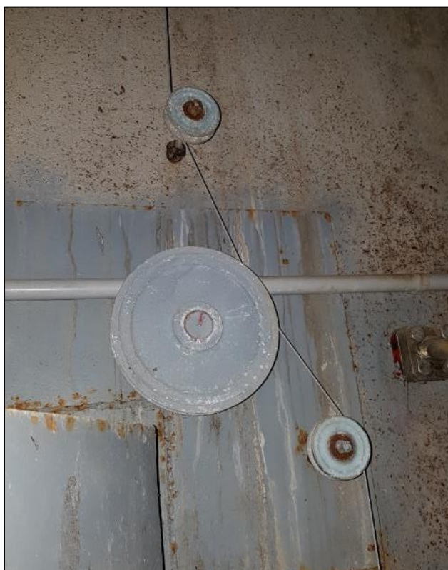
Figura 22 – Sistema di posizionamento
