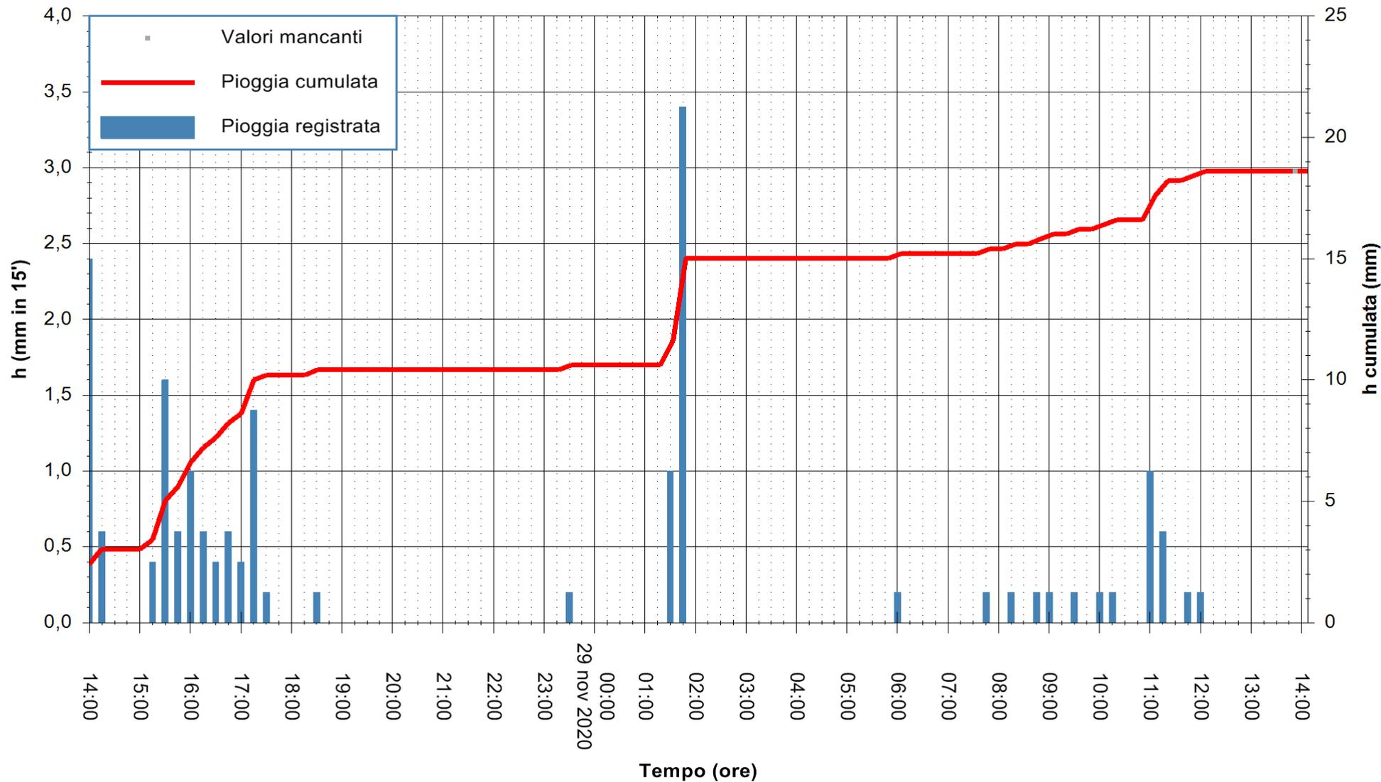
Stazione pluviometrica FLUMENDOSA A BALLAO RF
