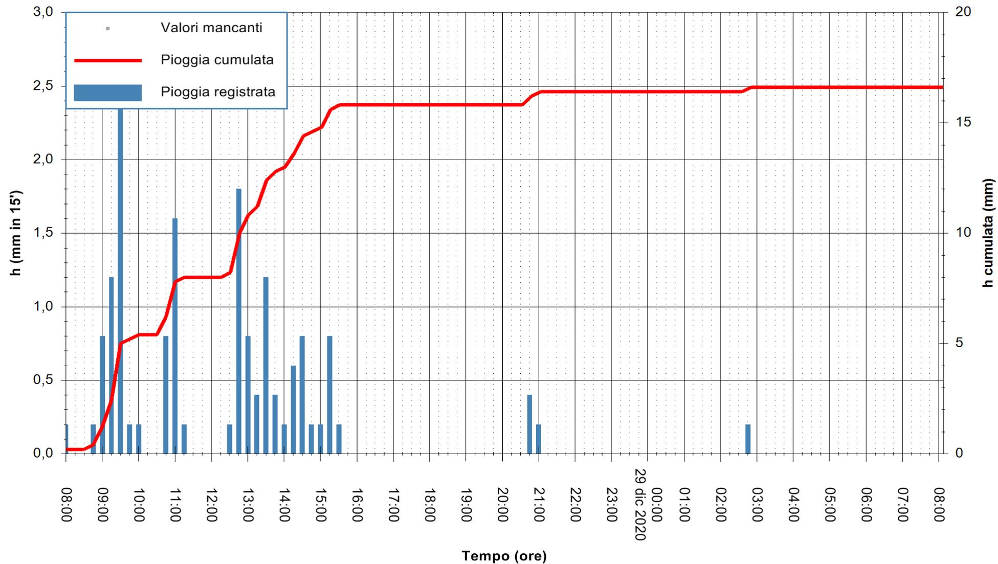
Stazione pluviometrica DIGA DEL CUGA
