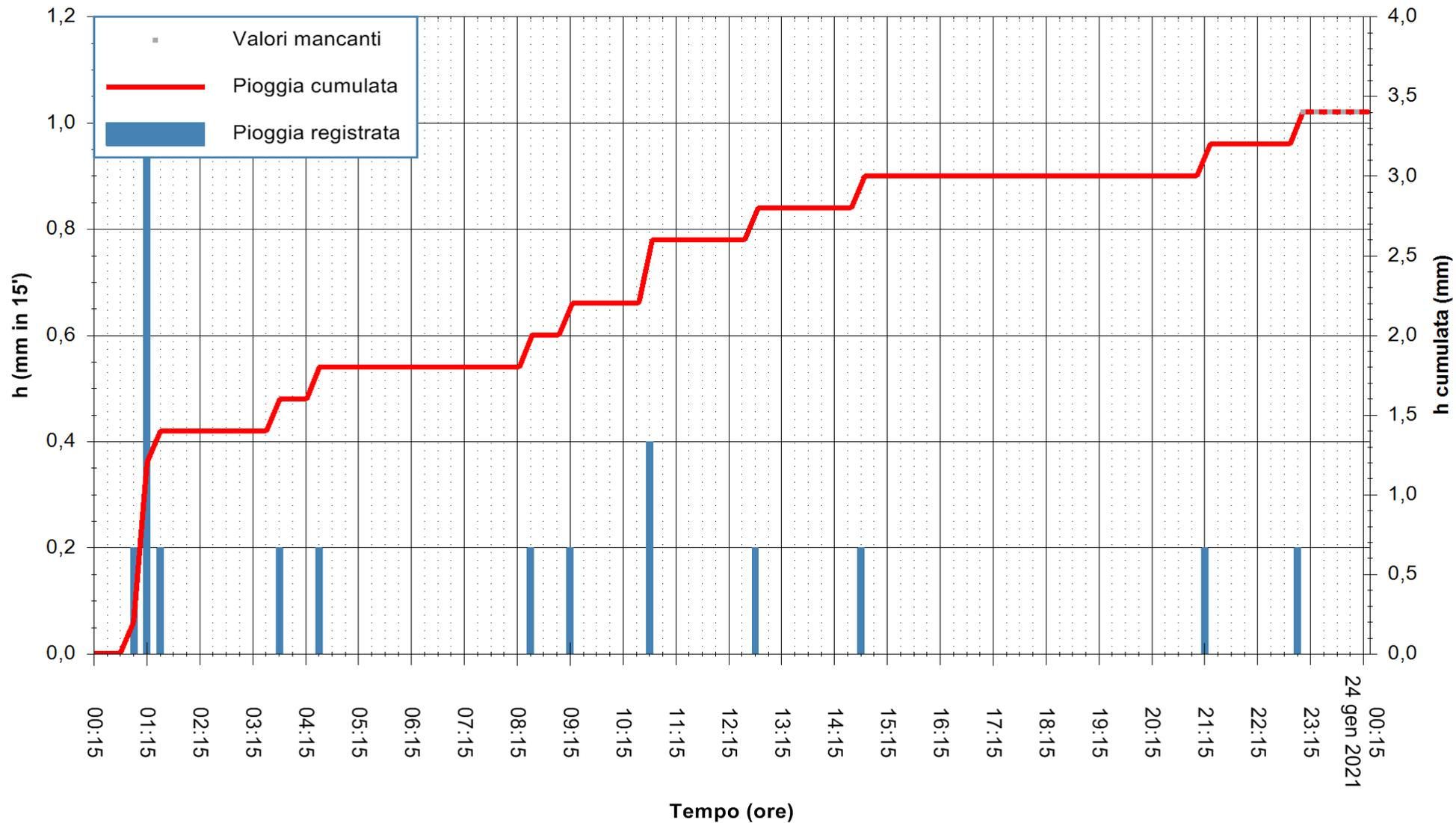
Stazione pluviometrica FLUMENDOSA A BALLAO RF
