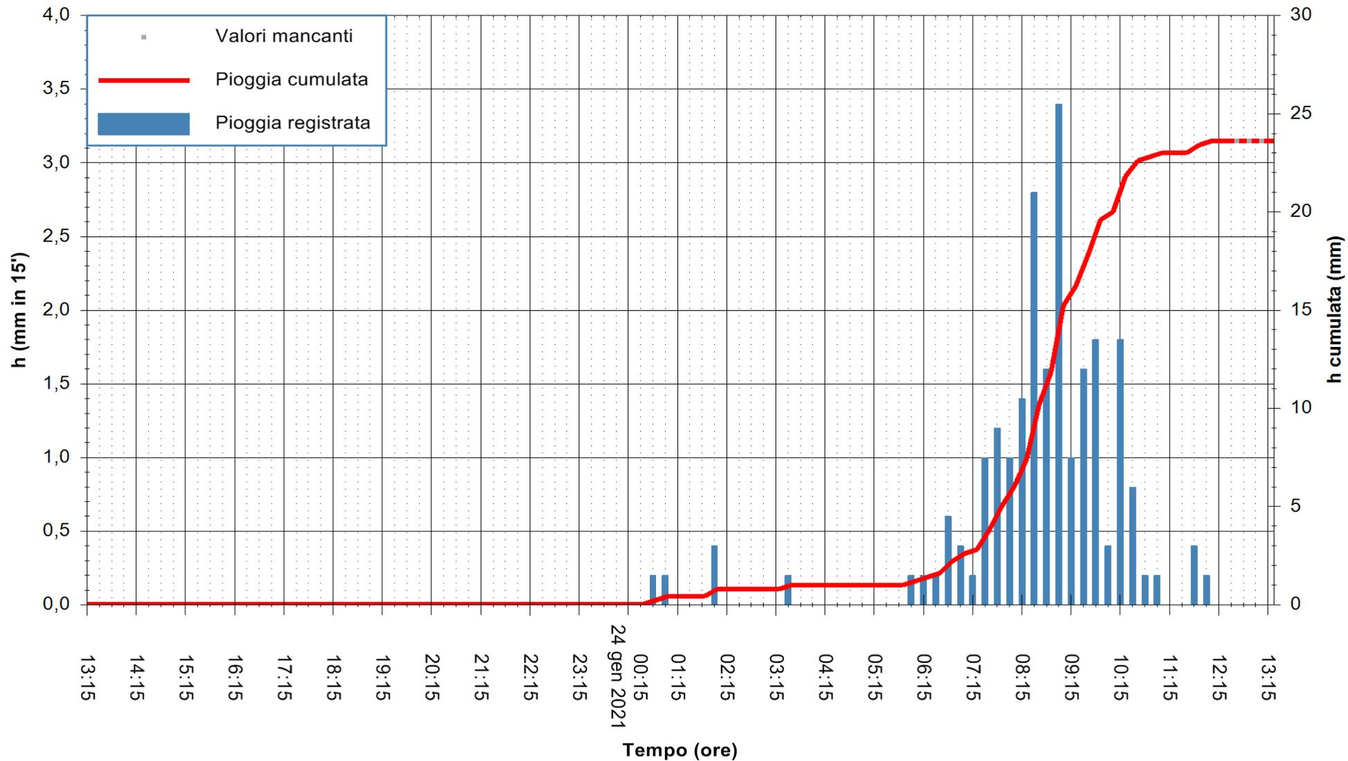
Stazione pluviometrica CARBONIA C.RA FLUMENTEPIDO
