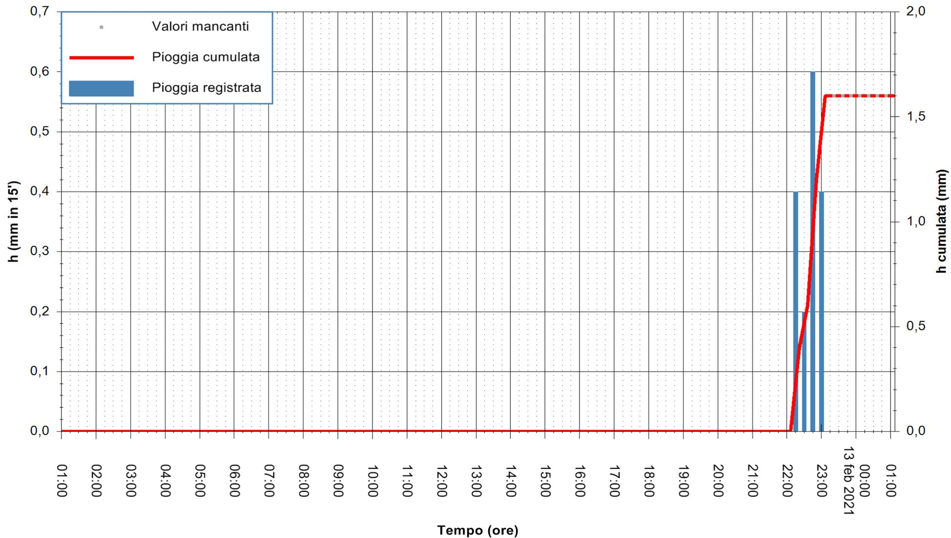
Stazione pluviometrica CARBONIA C.RA FLUMENTEPIDO
