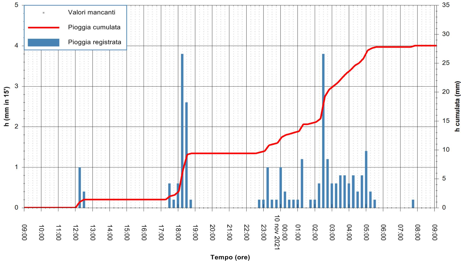
Stazione pluviometrica CARBONIA C.RA FLUMENTEPIDO
