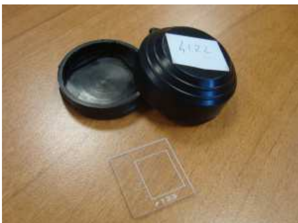
Fig. : a Sx: Il contenitore in plastica aperto e la lastrina in plastica; a Dx: il dosimetro nella sua configurazione di misura.
