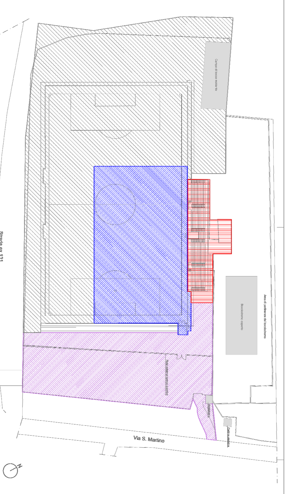
PLANIMETRIA CON L'UBICAZIONE DEGLI INTERVENTI DELLA PISCINA ALL'APERTO DA REALIZZARSI NELLA STESSA AREA, SCALA 1:200
