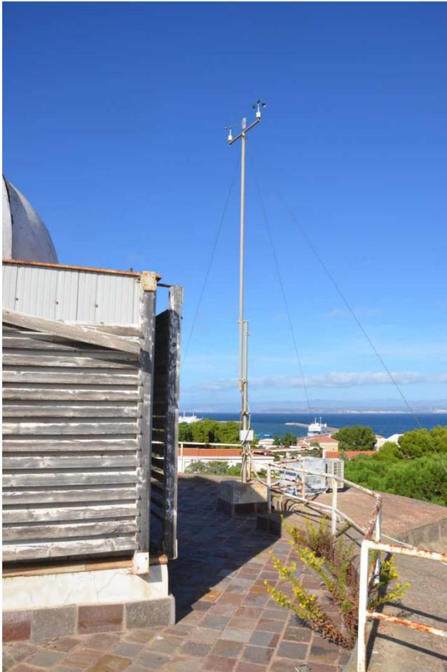
I sensori di temperatura, umidità relativa, radiazione solare e precipitazione dovranno essere installati sopra il supporto di cui alla **figura A1c** che ospitava alcuni sensori meteorologici del Servizio Meteorologico dell'Aeronautica Militare, eventualmente utilizzando staffe o altri elementi funzionali a una corretta installazione.
