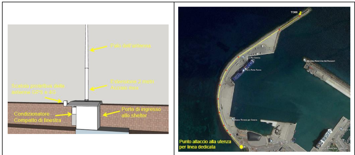
Figura 2: Schema di installazione e schema planimetrico della stazione radar HF nel molo di ponente del porto di Porto Torres
